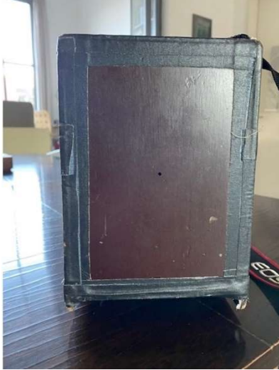
Abb. 6: Martin Streits camera obscura-Konstruktion, (Detail) Lochblende, Köln 2021. Foto: Martin Streit.
